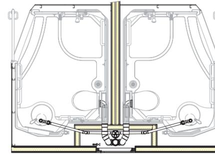
Principe de raccordement, ici représenté par Désirade 5 - sur chute unique avec sortie verticale en dalle.
