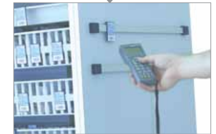
À des moments fixes pendant la semaine, un employé du service logistique scanne les étiquettes suspendues au rail.
