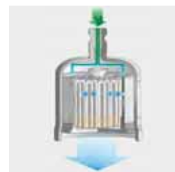
Passage de l'eau à travers le filtre
