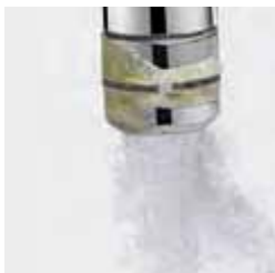
Jet avec aérateur entartré : éclaboussures
